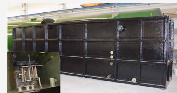
MBR contenerizado para aguas residuales
